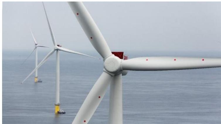
Abbildung 1: Offshore-Turbine mit Direktantrieb (154 m Rotordurchmesser mit 6 MW Leistung) [Quelle: Siemens AG]
