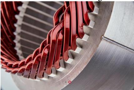
Abbildung 1: Wickelkopf eines Elektromotors mit Hairpin-Wicklung, Quelle: <https://www.aumann.com/>
