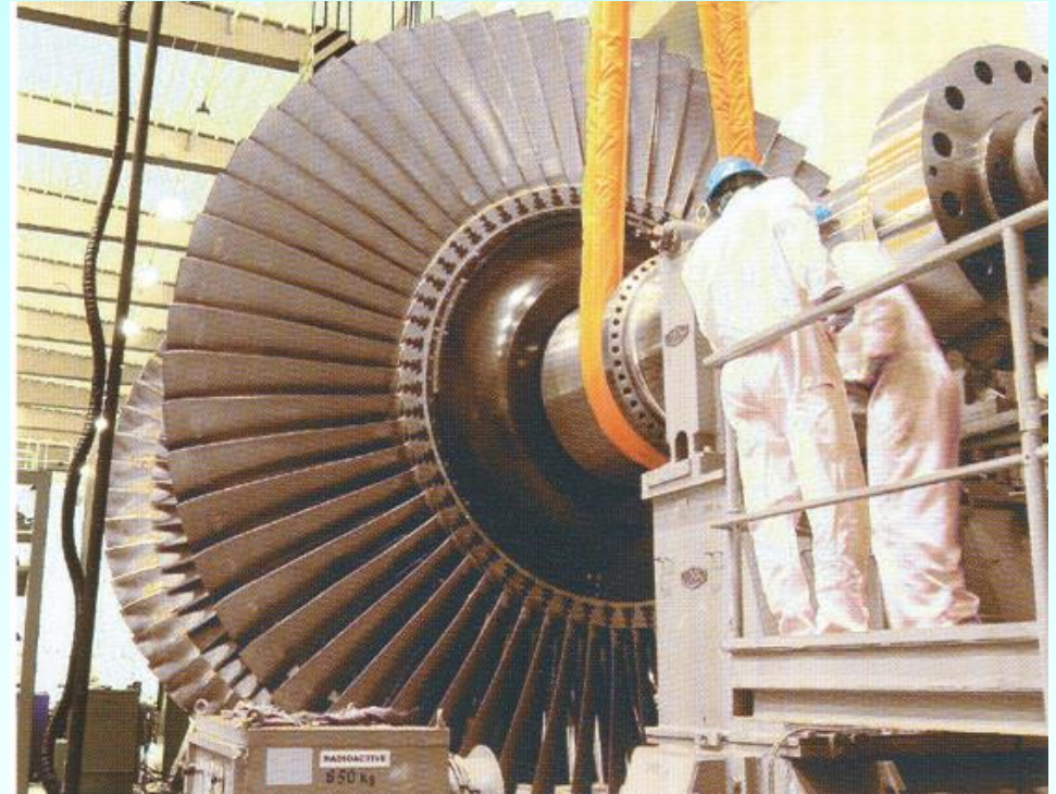
Zweiflutiger Turbinenrotor aus Rotorscheiben (Masse 260 Tonnen), Flügelspitzen der Endreihen: Überschall
