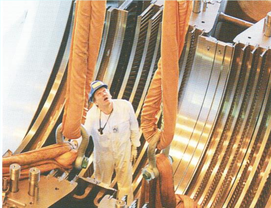
Untere Gehäusehälfte mit den Leitschaufeln zur Dampfumlenkung
