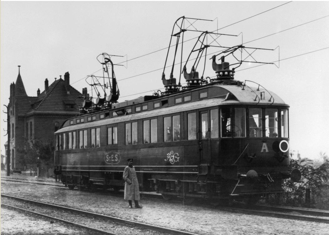
**Der Drehstrom-Schnelltriebwagen der AEG fährt am 28. Oktober 1903 einen Geschwindigkeitsrekord mit 220.2 km/h ein.**
