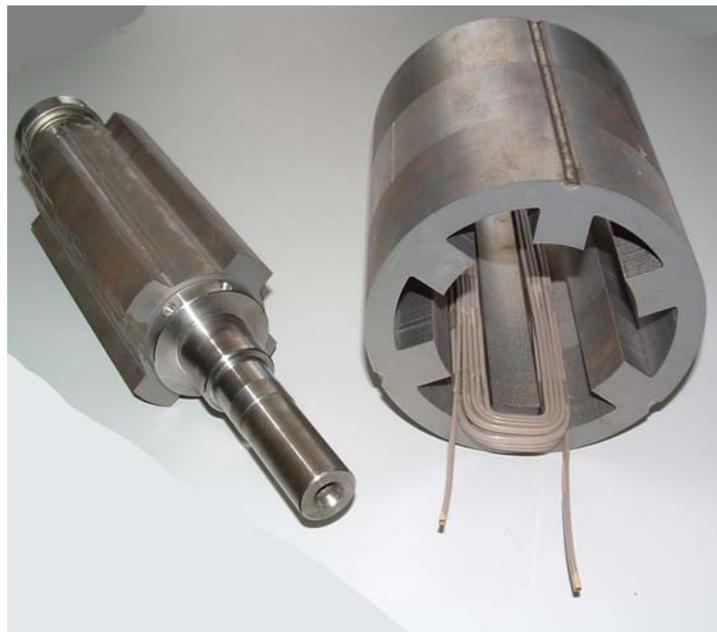
Bild 4.1.4-6: Läufer und Statorblechpaket eines 3-phasigen, zweipoligen 6/4-geschalteten Reluktanzmotors
