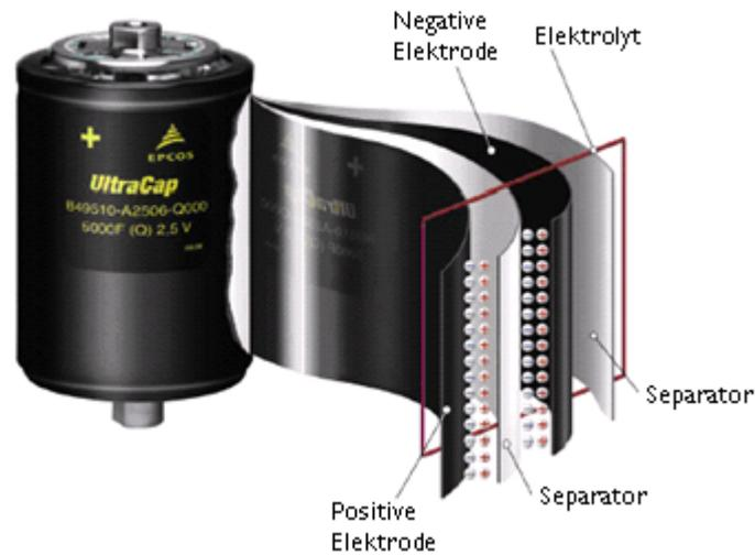
Bild 7.1-1: Aufbau eines UltraCapacitors ([http://www.epcos.com/inf/20/35/ds/ultracap\\_2005.pdf](http://www.epcos.com/inf/20/35/ds/ultracap_2005.pdf))
