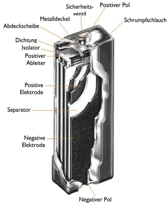
Bild 6.5-1: Ni-MH-Akku mit prismatischem Aufbau (Duracell, <http://www.duracell.com/oem/Pdf/others/TECHBULL.pdf>)
