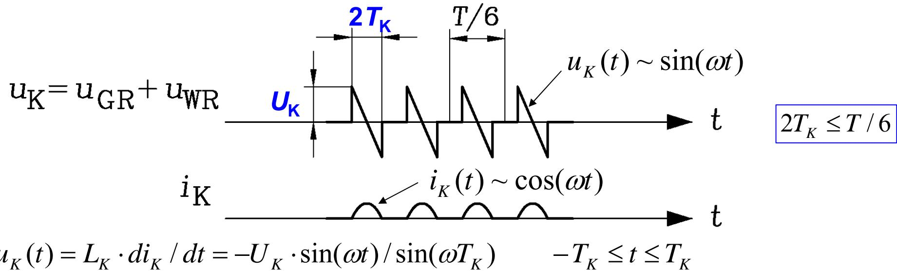
$$i_K(t) = \int u_K(t) \cdot dt / L_K = \frac{U_K}{\omega L_K \cdot \sin(\omega T_K)} \cdot (\cos(\omega t) - C) \quad i_K(t = -T_K) = 0 \quad C = \cos(\omega T_K)$$
