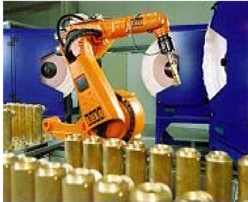
Ein-Arm-Roboter mit PM-Synchronantrieben
