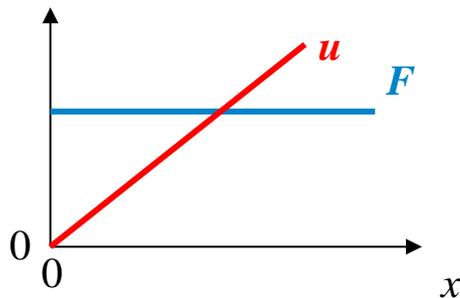
Bei konstanter Plattenladung  $Q$  und homogenem Feld  $E = \text{konst.}$  zwischen den Platten
