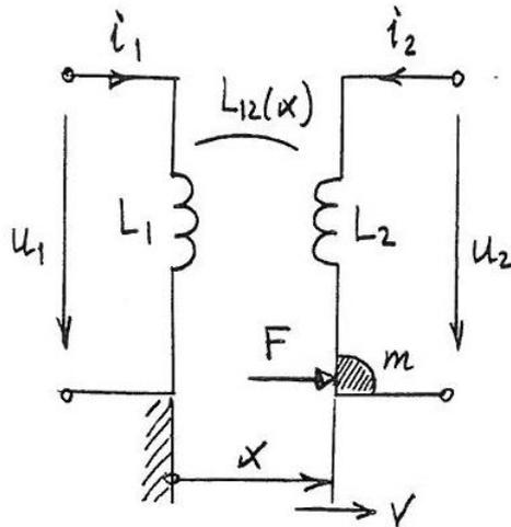
Zwei magnetisch gekoppelte ( $M = L_{12} = L_{21}$ ) **lineare** Spulen ( $L_1, L_2$ )
