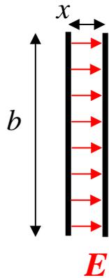
Bei gegenüber Plattenabmessungen  $b, l$  **großem Plattenabstand**  $x$  darf das „ausufernde“ Randfeld nicht vernachlässigt werden und bestimmt maßgeblich das Feld zwischen den Platten, so dass  $E(x)$  zwischen den Platten ein Minimum hat!
