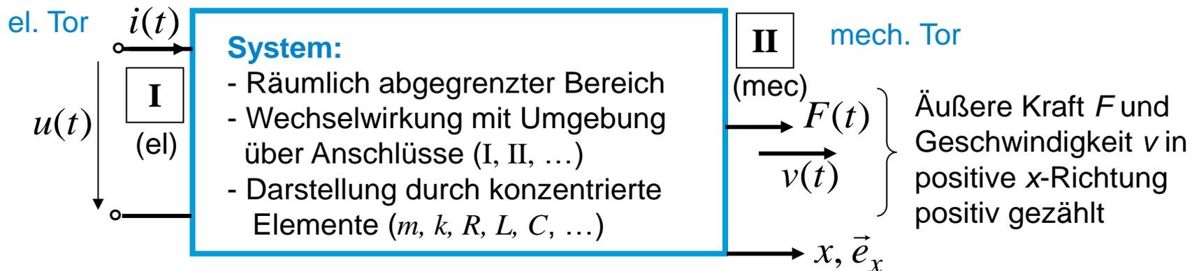
**Beispiel:** Wandler aus Kap. 2 „Grundlagen“: Wechselwirkung mit Umgebung über ZWEI Anschlüsse I, II („Tore“): Ein elektrischer (el) und ein mechanischer (mec) Anschluss!
