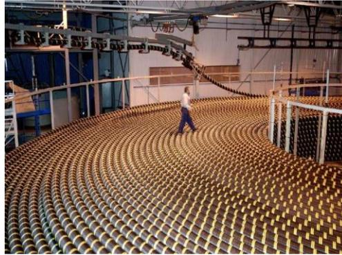
Bild V4.4-27: Gelagertes HGÜ-Tiefseekabel (Quelle: [www.pro-erdkabel-neuss.de](http://www.pro-erdkabel-neuss.de)).
