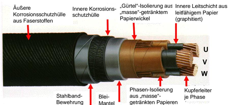
Bild V4.4-7: Dreiphasiges „Masse“-Mittelspannungskabel (Quelle: J. Hanson).
