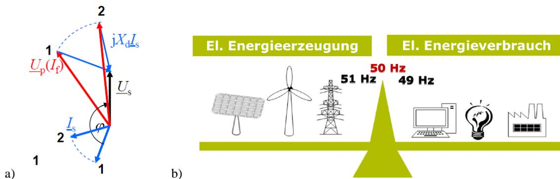
Bild V2.1-3: a) Blindleistungsänderung von Zustand 1 nach 2 bei  $U_s = \text{konst.}$  über Verstellung (hier: Erhöhung) des Generator-Erregerstroms  $I_f$ , b) „Stromwaage“ zur Abhängigkeit der Netzfrequenz von der Wirklastdifferenz zwischen Angebot (el. Energieerzeugung) und Nachfrage (el. Energienutzung) (Quelle: J. Hanson).
