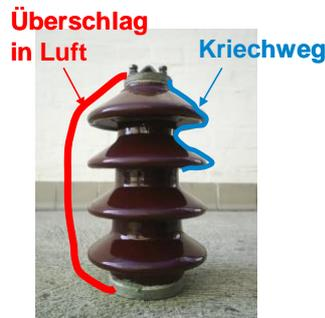
Bild V4.3-15: 30-kV-Porzellanisolator mit 4 glockenförmigen Rippen als Schirme zur Verringerung von Kriechströmen. Eingetragen sind die Wege des Luft- und Kriechweg-Überschlags.
