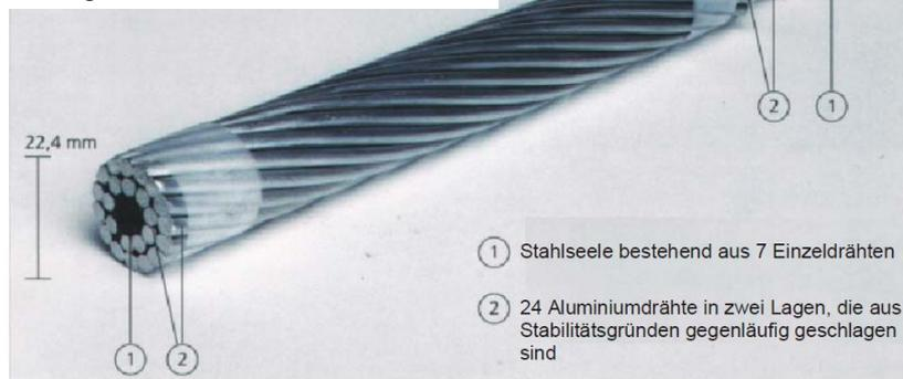
**Bild V4.3-13:** Aluminium-Stahl-Leiterseil einer Freileitung (Quelle: *Wikipedia.de*).
