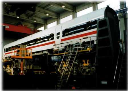
ICE auf dem Rollprüfstand
