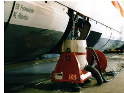
Hydraulischer Heber an Anhebestelle eines ICE 2-Wagenkastens
