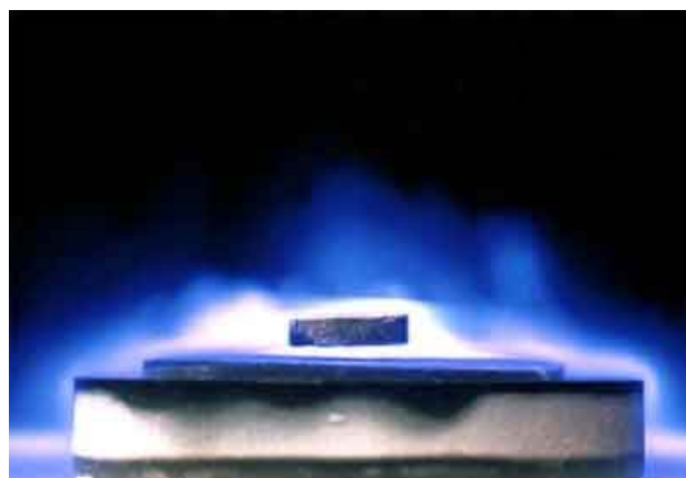
Bild 1.1.2-3: Meissner-Ochsenfeld-Effekt: Experiment: Ein Permanentmagnet schwebt über einer supraleitenden HTSL-Scheibe stabil (Quelle: Internet)
