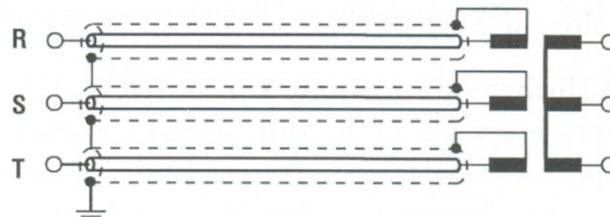
Bild 2.2.2-2: Vollständige Kompensation des äußeren Magnetfelds der drei Kabelstränge durch Rückführung des Transformator-Sternpunkts über die äußeren Schirmleiter [2.1]
