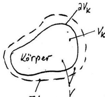
Wir umgeben den betrachteten Körper mit einer geschlossenen Fläche  $\partial V$ , die ganz im leeren Raum (oder außerhalb des Feldbereichs) verläuft. Für die resultierende Kraft ergibt sich unter Verwendung von (23)<sub>1,2</sub> und (25)<sub>1,2</sub>
