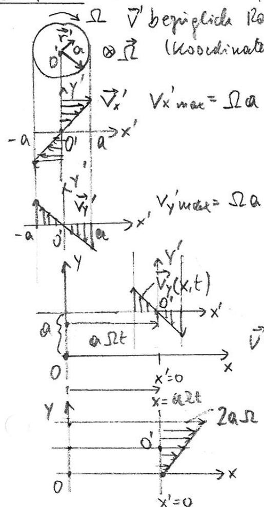
$\vec{v}'$  bezüglich Radkontaktpunkt  $O'$ :  $\vec{v}' = \vec{\Omega} \times \vec{r}'$  ( $\vec{r}' = \vec{x}'$ )
