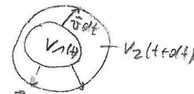
$$d(V_2 - V_1) = dA_n \cdot \vec{v} dt$$
