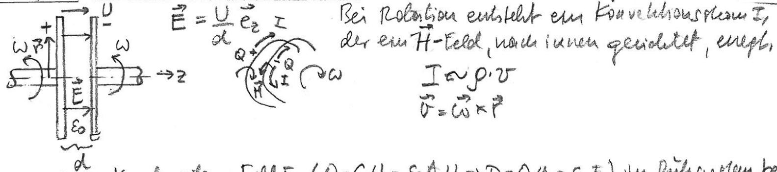
geladener Kondensator: Feld  $E$  ( $Q = C \cdot U = \frac{\epsilon_0 A}{d} U \Rightarrow D = Q/A = \epsilon_0 E$ ) im Ruhesystem, bei  $\omega = 0: H = 0$  im Ruhesystem. Im bewegten System (mit  $r \gg d$  als Linearbewegung
