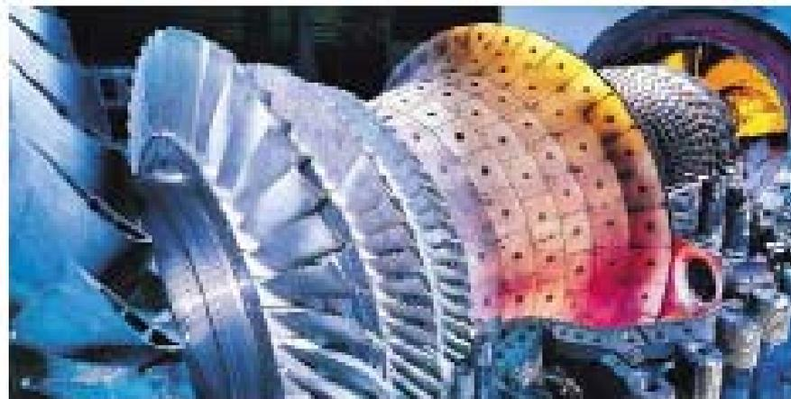
Gasturbine: Numerische Strömungsoptimierung der Beschaufelung
