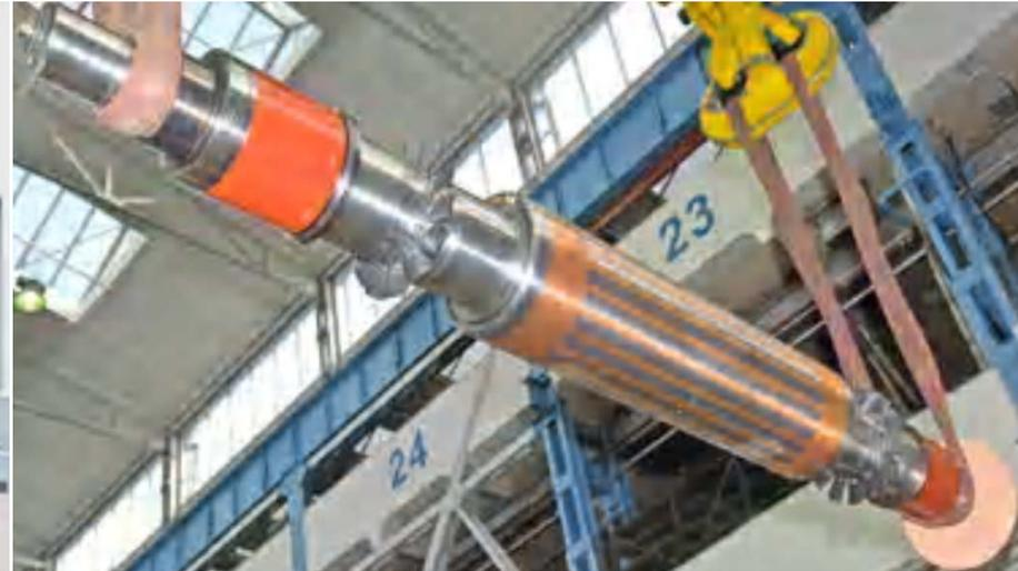
15000/min, 4 MW Käfigläufer-Asynchronmotor
