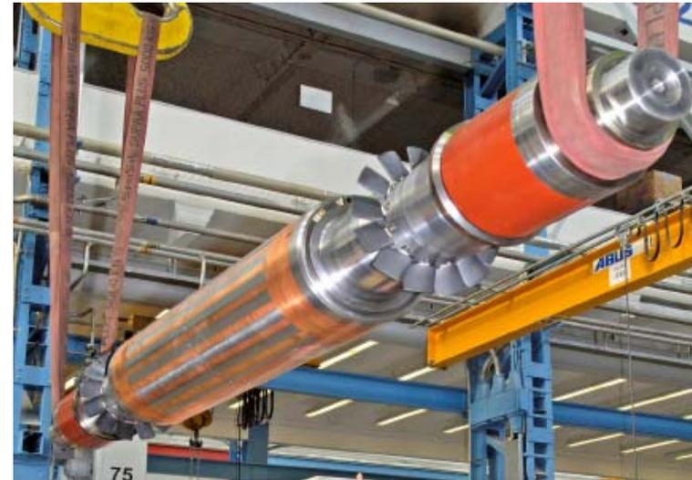
15000/min, 4 MW Käfigläufer-Asynchronmotor
