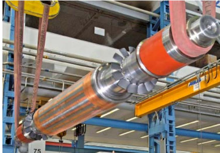
15000/min, 4 MW Käfigläufer-Asynchronmotor
