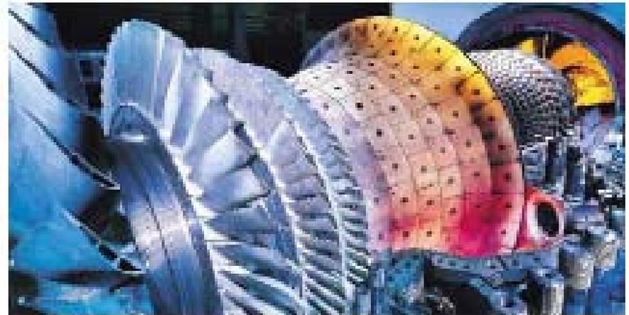
Gasturbine: Numerische Strömungsoptimierung der Beschaufelung
