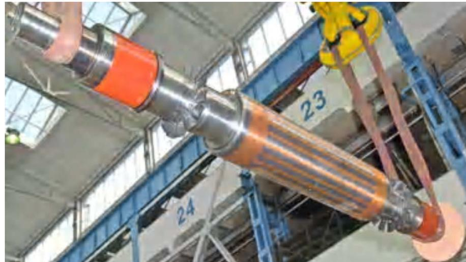
*15000/min, 4 MW Käfigläufer-Rotor*
