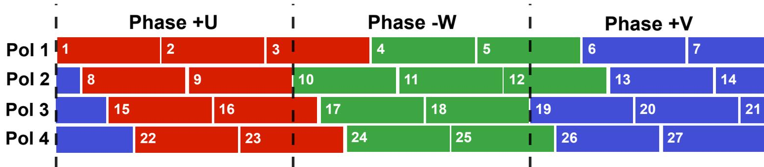
Bei einer Bruchlochwicklung ist aufgrund der Phasenverschiebung der Zähler der Lochzahl (hier  $q_Z = 9$ ) massgebend.
