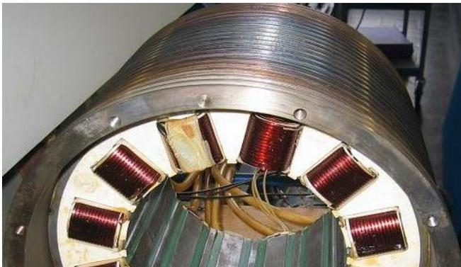
**Maschine 3: Einschichtwicklung, 6-polig**
