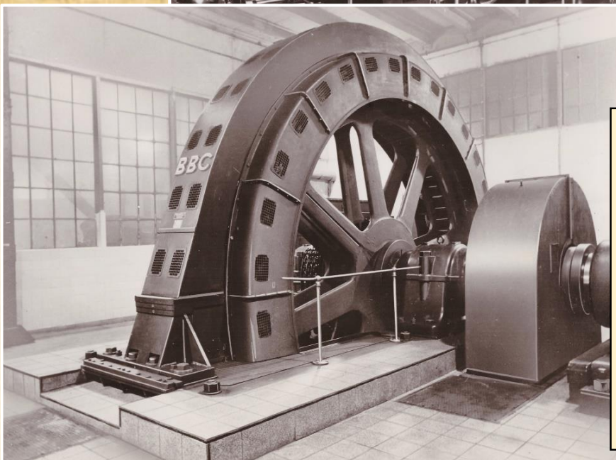
Mitteldeutsche Stahl- und Walzwerke Brandenburg Asynchronmotor MS 5884 c spez. 20'000 kVA 5000 V 71,5 U/min 5
