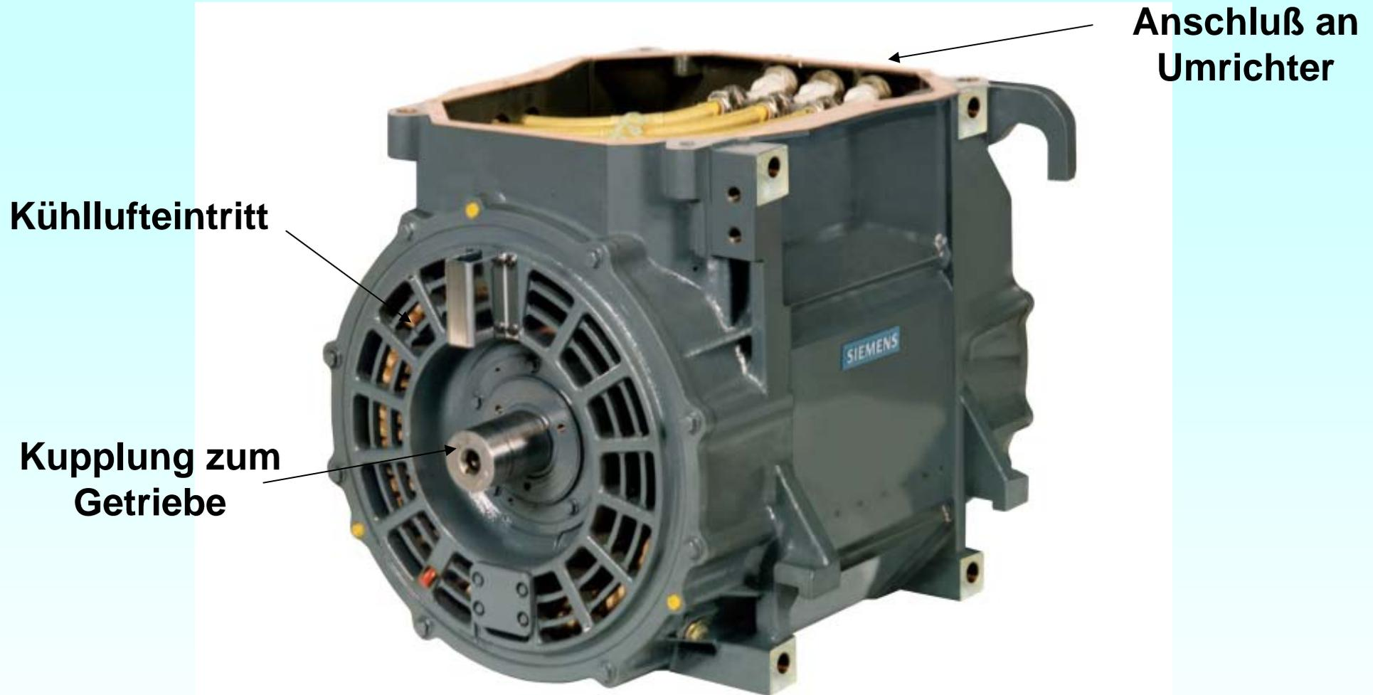
**ICE 3-Fahrmotor**, Asynchronmotor mit Kupfer-Kurzschlußkäfig-Läufer,
