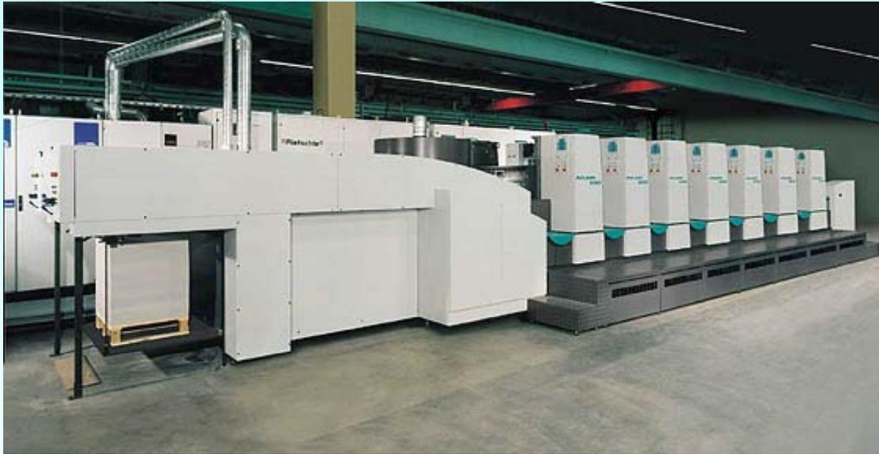
Ersatz der Königswelle mit dem Zentralantrieb durch verteilte, winkelsynchron drehende Einzelantriebe:
