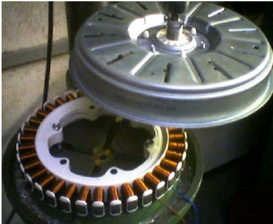
Beispiel: PM-Waschmaschinenantrieb mit Außenläufer, Zahnpulen, Luftkühlung
